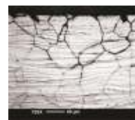
Ανάπτυξη νηματοιειδούς διάβρωσης στο μικροσκόπιο (20μm)
